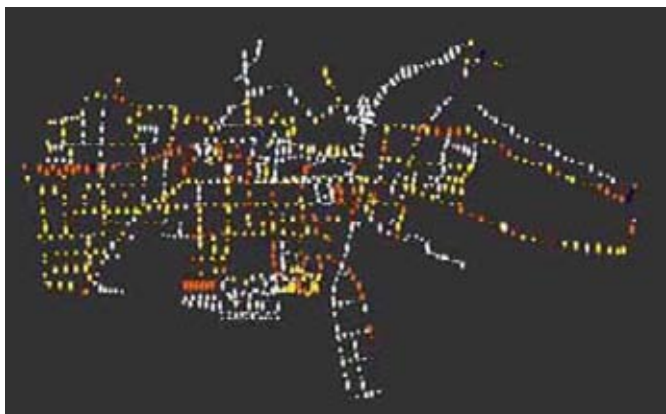
Stav stožárů: ● - dobrý, ● - zhoršený, ● - špatný
