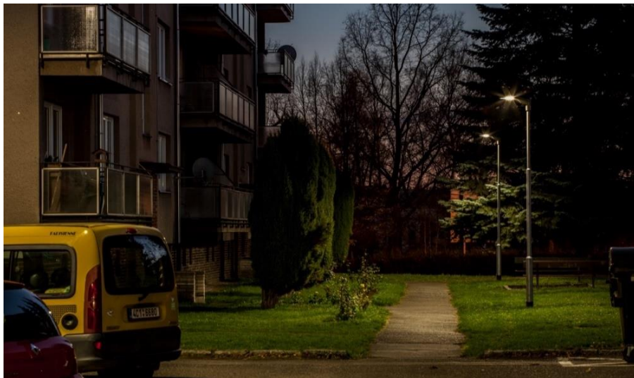
Obrázek 9 LED Svítidla moderního VO umožňují směřování světelného toku do míst, kde je užitečný. (foto: ETNA s.r.o.)
