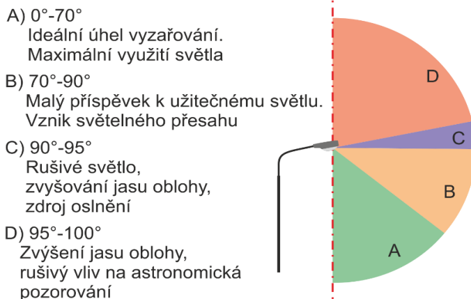
Obrázek 22 Klasifikace využití světla vyjádřena úhlovými výsečemi vyzařovací charakteristiky svítidla (zdroj: vlastní)
